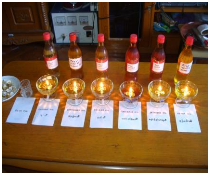
Thử nghiệm các loại dầu thực vật để làm phương tiện chiếu sáng
