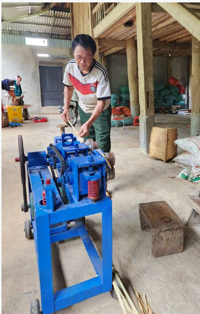
Hình 10: Máy tuốt nan tre đã giúp nhóm Tre bản Thín tăng năng suất lao động lên đáng kể
